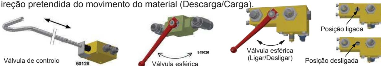
6. Empurre o manípulo da válvula esférica (consultar figura acima) para a posição totalmente aberta (DESLIGADO). O piso não irá funcionar! O manípulo da válvula esférica está localizado entre as linhas de pressão e retorno. **NOTA:** a válvula esférica controla as ações Ligar/Desligar e é utilizada como uma paragem de emergência.
