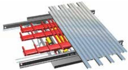
**Etape 3** Cylindre n ° 3 (et n ° lattes 3) se déplace vers l'avant de la remorque, maintenant la charge ne bouge plus. A la fin de cette phase, quand tous les cylindres sont ensemble, le cylindre croise visse au n ° 3 active la valve de changement. Ce qui change la pression à l'avant de tous les cylindres et commence la phase 4.
