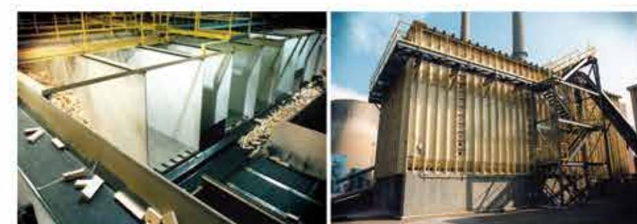
WALKING FLOOR® 저장시스템은 다양한 재활용품과 나무 제품, 퇴비 및 기타 사용을 위한 저장 공간을 제공합니다. 또한 공간과 노동을 절약하기 위하여 추가 처리를 위한 자재를 자동으로 공급합니다.
