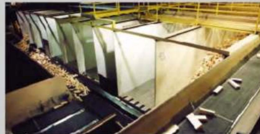
▲ Placés côte à côte, les silos WALKING FLOOR® offrent un espace de stockage à usage multiple pour des matériaux recyclables, produits en bois, le composte et autres applications. Dans l'industrie du bois des produits secondaires, les silos WALKING FLOOR® permettent de stocker des blocs de bois de différentes épaisseurs. Les silos alimentent automatiquement les chaînes d'aboutages avec le bois, ce qui génère une économie en travail et en espace.
