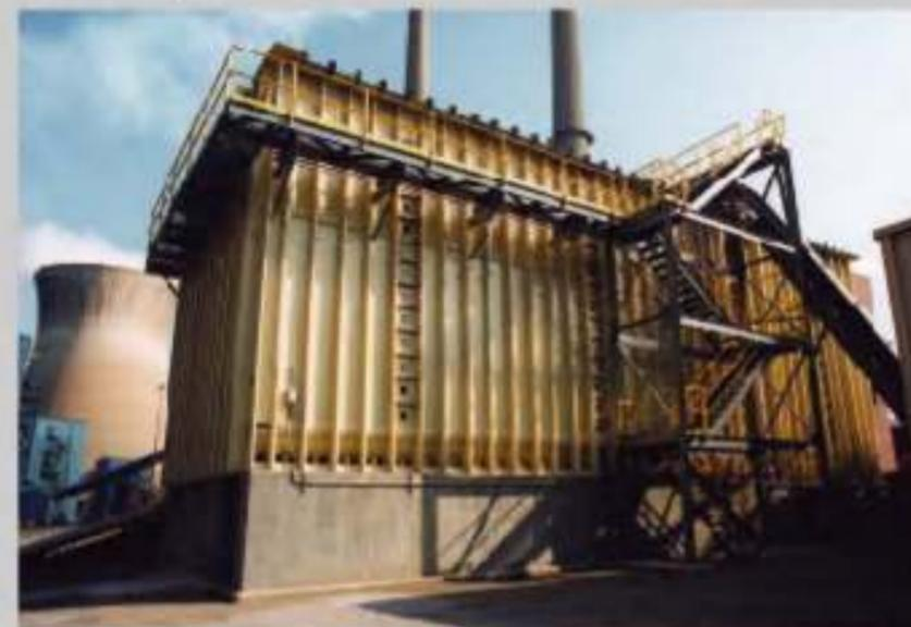
Le silo de dosage WALKING FLOOR® offre une capacité de stockage de 20 à 2800 tonnes et plus. Parfaits pour stocker et transporter des matériaux de difficile manipulation, ces silos de dosage permettent une vraie rotation FIFO (First-In, First-Out) et un contrôle précis. Ce silo est utilisé dans une centrale thermique au charbon à des fins de stockage et dosage des morceaux de bois brut.
