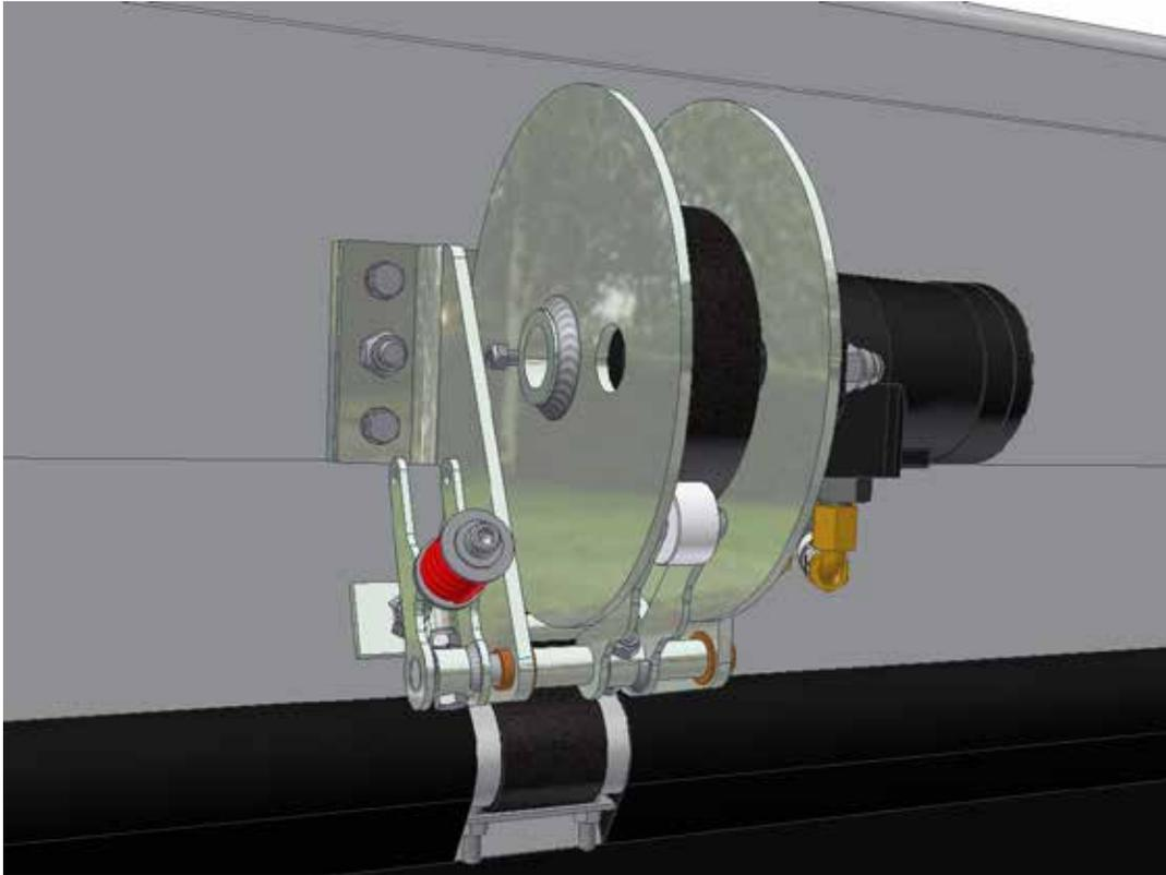
**Schéma 2: Treuil monté en haut de la paroi avant de la remorque.**
